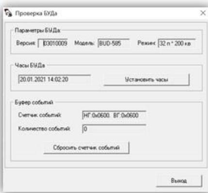
**Версия:** отображается версия БУДа. Поле доступно только для чтения (определяется автоматически при скачивании конфигурации из БУДа).
